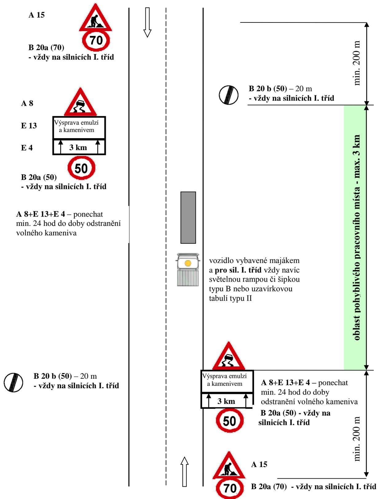
**Schéma č. 2.1.: Výspravy vozovek obalovanou živичnou směsí s případným frézováním poruchy – v obci**
