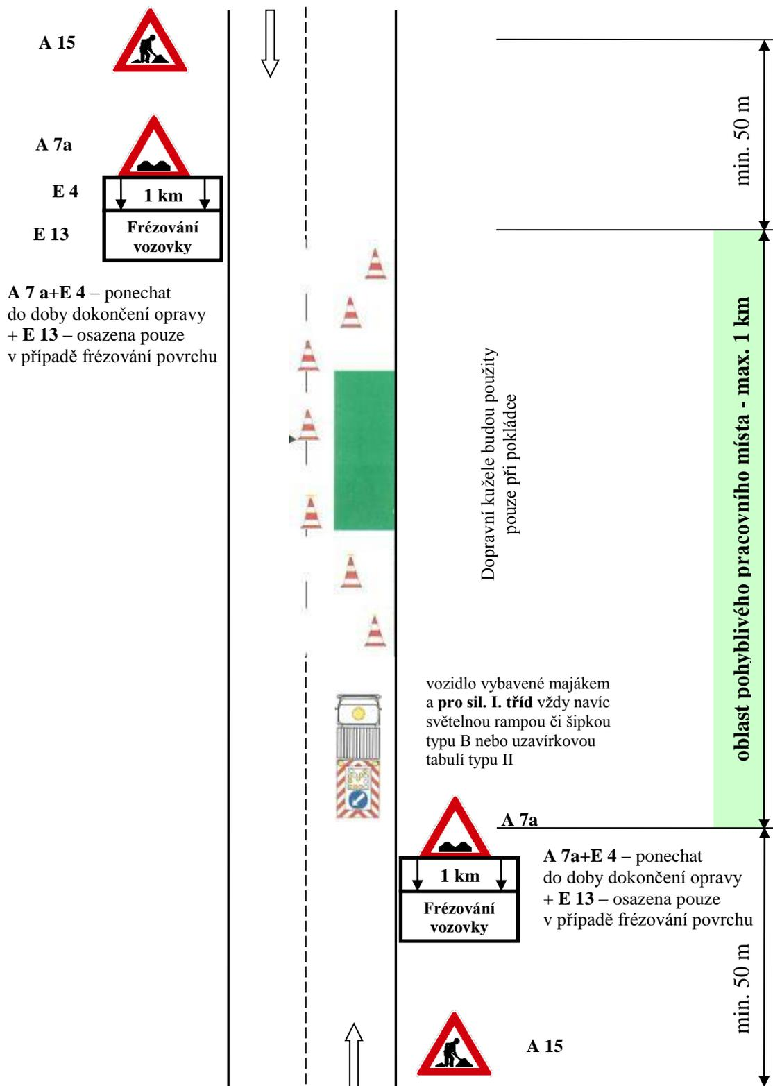
**Schéma č. 2.2.: Výspravy vozovek obalovanou živичnou směsí s případným frézováním poruchy – mimo obec**
