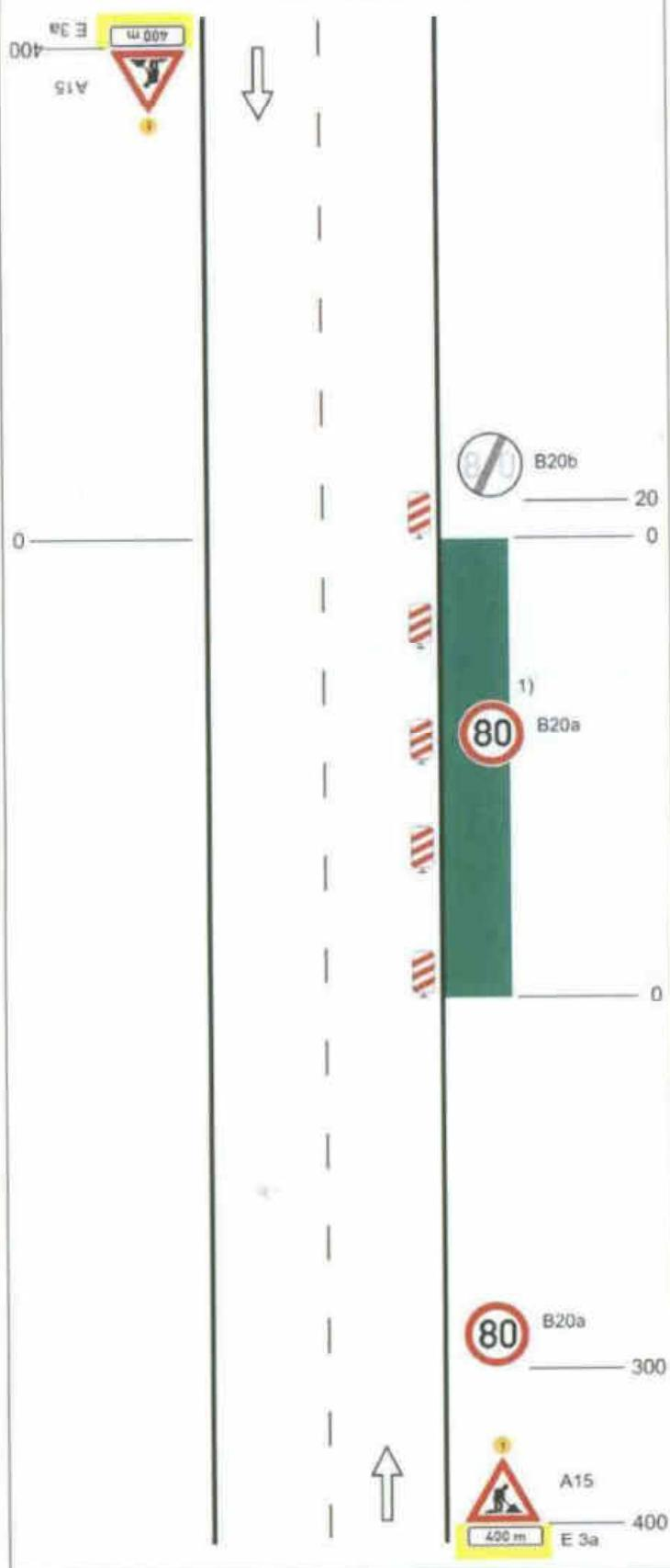
podélná uzávěra oboustrannými směrovacími deskami odstup max. 20 m
